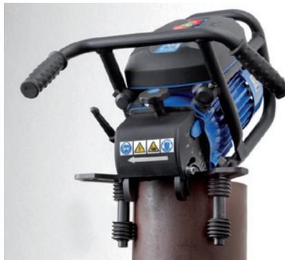
Kantenbearbeitung von Rohren in vertikaler Position
