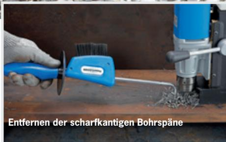
Entfernen der scharfkantigen Bohrspäne
