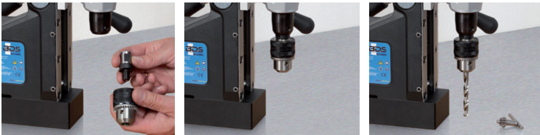
1. Adapter mit Bohrfutter verbinden. 2. Bohrfutter in die Direktaufnahme einsetzen. 3. Einsatzbereit für Spiralbohrer.
