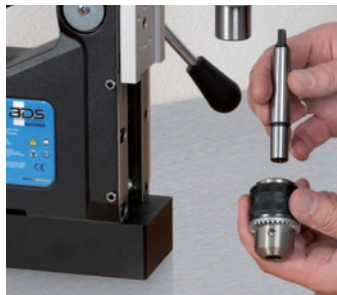
1. Kegeldorn mit Bohrfutter verbinden. 2. Bohrfutter in MK-Aufnahme einsetzen. 3. Einsatzbereit für Spiralbohrer.
