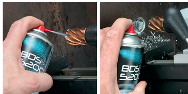
Schritt 1: Vor dem Bohrvorgang Hochleistungs-fettspray direkt in den Bohrer sprühen.
