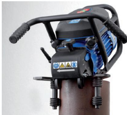
Kantenbearbeitung von Rohren in vertikaler Position
