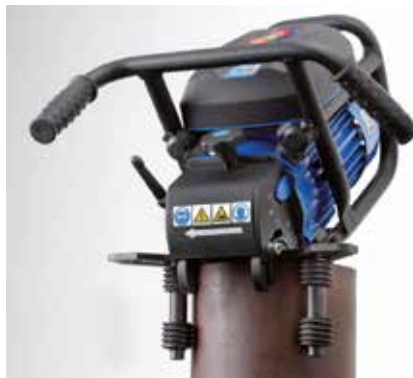
Kantenbearbeitung von Rohren in vertikaler Position
